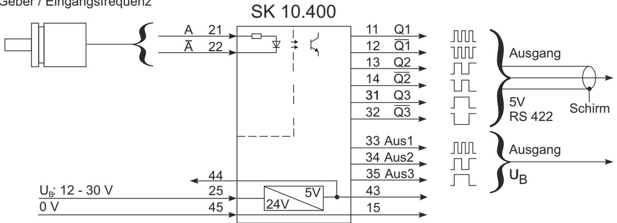
**SK10.400** Signalpegelumsetzung von 5 V auf 24 V-Signale oder 24 V auf 5 V-Signale
